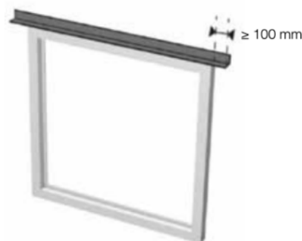
Figure 11 : Pose avec débordement
